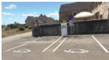
La station de recharge de véhicules installée à Fyé est une infrastructure équipée de deux bornes permettant la recharge de deux véhicules électriques (trois heures pour une charge complète). La borne a été mise en service fin 2021 et elle est située rue Geneviève Hobey, angle du chemin de Dadam.
